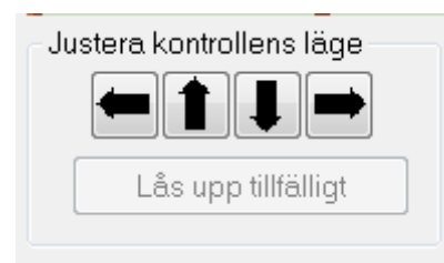
Fig 4 – Pilar för finjustering av Kontrollcirkelns läge
